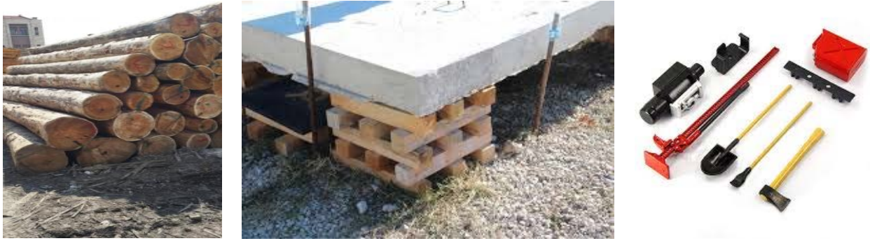
Şekil 2. Enkaza girebilmek ve enkazda ilerleyebilmek için, çeşitli ahşap tahkimat gereçleri
